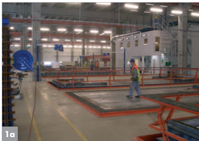
Colocación de los encofrados laterales con ayuda de un sistema láser
