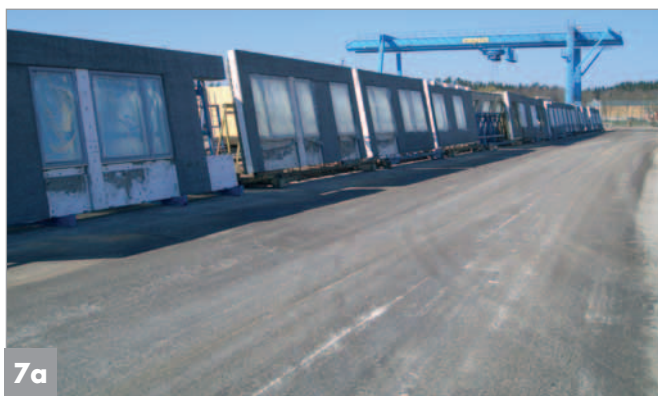
El manejo de los elementos en el almacén se realiza con varias grúas pórtico
