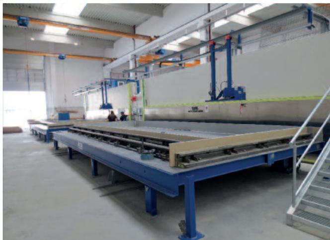
Опалубочная станция с лазерным проектором
