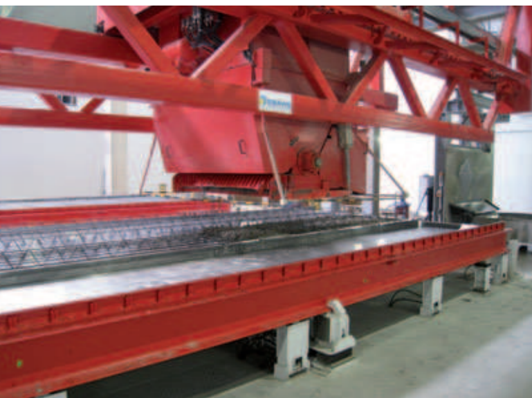
Estación de hormigonado.
