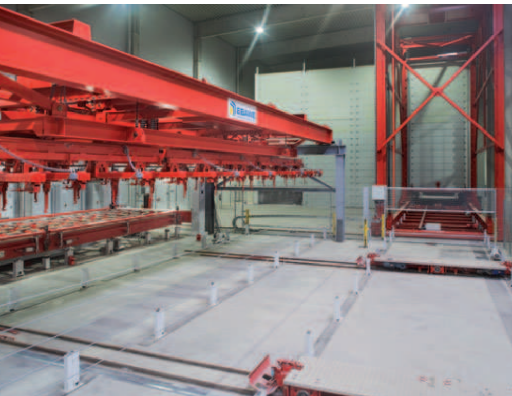
Imagen del área de virado de las paredes dobles.
